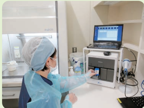
検体が入ったカートリッジをセットして解析します
